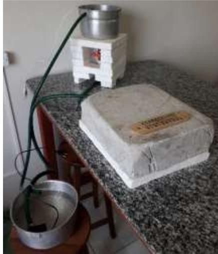
Para o aquecimento da água foi utilizado um resistor semelhante ao do chuveiro. A fonte de água quente foi posicionada na parte superior e a fonte de água fria na parte inferior. Por gravidade, a água quente desce para a fonte fria. Utilizando uma bomba de aquário, a água da fonte fria é novamente bombeada para o reservatório superior, onde é novamente aquecida.
